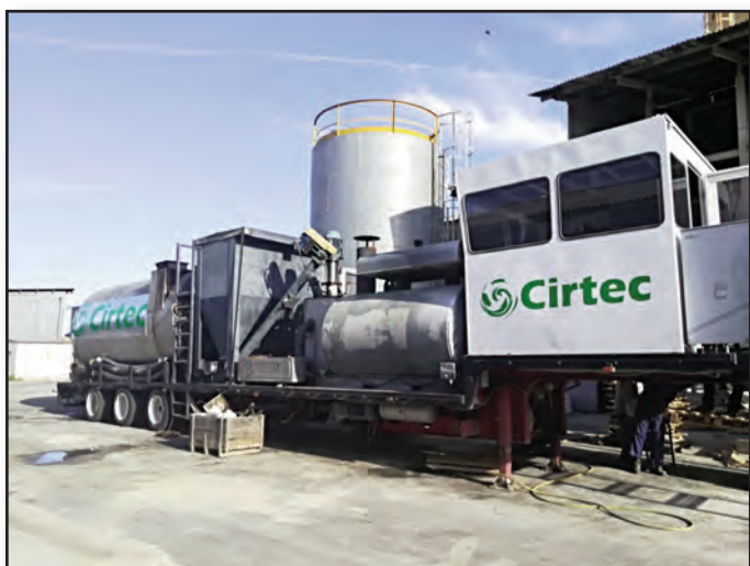
Máquina con modificación de betunes móviles con polvo neumático
